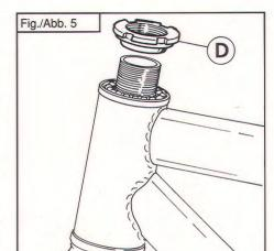
Avvitare la ghiera (D, Fig. 5) del cuscinetto superiore fino al punto in cui l'asse di sterzo risulterà libero di ruotare senza alcun gioco.
